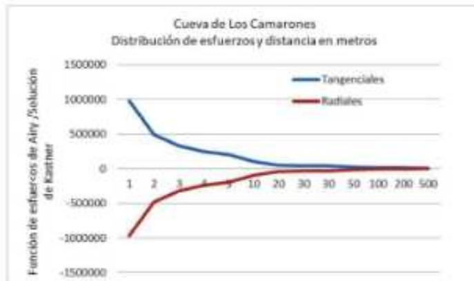
**Fig. 8. Distribución de esfuerzos tangenciales y radiales de la Cueva de Los Camarones para una carga de 2500 kg/m<sup>2</sup> (24,5 kPa)**
