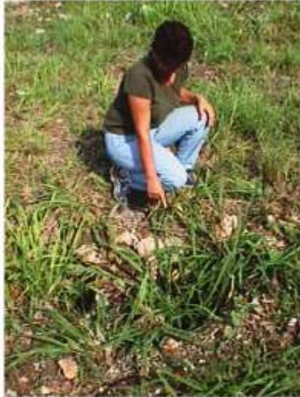
**Fig. 12. Subsistencia en el área de la Cueva de Los Camarones asociada a lavado del material de relleno por tubificación (piping).**
