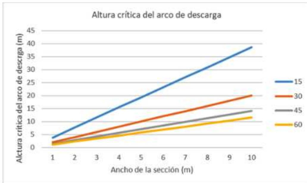
Fig. 10. Nomograma para el cálculo de la altura crítica del arco de descarga de una galería excavada en función del ancho de la sección y el ángulo de fricción interna de las rocas. Para operar con el nomograma se entra por el ancho de la sección perpendicularmente a intersectar la recta que marca el ángulo de fricción interna del material rocoso. El nomograma ha sido simplificado para valores de  $\phi$  de 15, 30, 45 y 60°.
