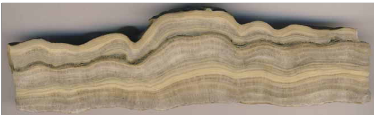
Figura 1. Imágenes de luminiscencia estimulada con rayos UV (arriba) y con reflectancia (abajo) de un depósito de travertino, de unos 3.5 cm de espesor, proveniente de un alero en el S de la Patagonia. Las capas oscuras, marrones y negras, son las ricas en carbonato con detrito.
