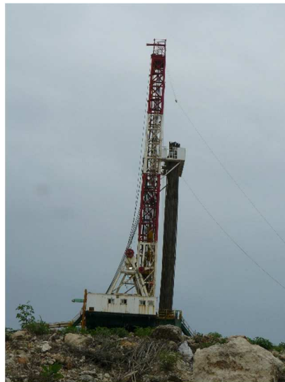
Fig. 33. Perforación para ensayos de presión y dilución en acuífero somero salinizado (Foto del autor)
