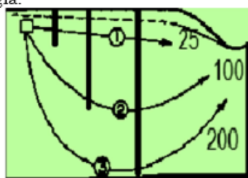
Fig. 2. Esquema de circulación de las aguas modificado de Swinnerton (1932) para ejemplificar distintos tiempos de residencia (en años) de las aguas subterráneas en cada línea de flujo (líneas curvas numeradas) intersectados por pozos (líneas verticales). La inyección de la mezcla de aguas producidas (MAP) debe seleccionar el tiempo requerido para garantizar la mezcla total para el umbral de sensibilidad ambiental requerido para tiempos de inyección constante o variable.
