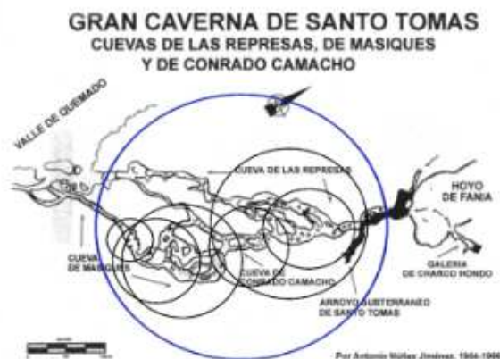
Fig. 14. Proyección del campo de distribuciones de tensiones límite en un sector de la Gran Caverna de Santo Tomás, Pinar del Río, Cuba (sobre el mapa de Antonio Núñez Jiménez). Los círculos negros indican los cambios a aproximadamente 2D. el círculo azul representa la suma (envolvente) de los esfuerzos límite en las secciones más anchas de la galería y salones, en la que los esfuerzos se superponen. Nótese la clasificación adicional a la que eventualmente ha contribuido el acomodo de esfuerzos tangenciales y radiales.
